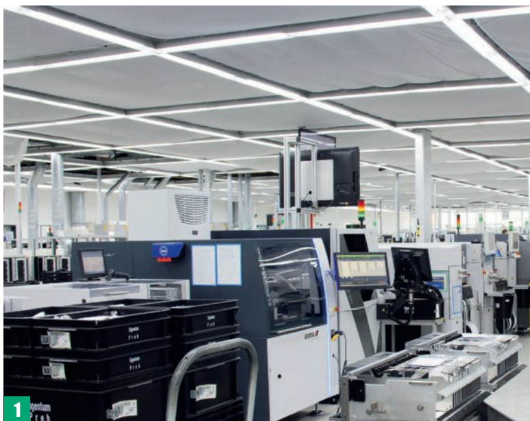
Bild 1: Die Linie 6 in der Fertigung bestückt die Stromschienen für die Steuerungsgeräte von E-Fahrzeugen.
