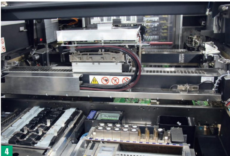
Bild 4: Blick in den Bestückungsautomaten bei der Stromschienen-Bestückung aus dem Tray.
