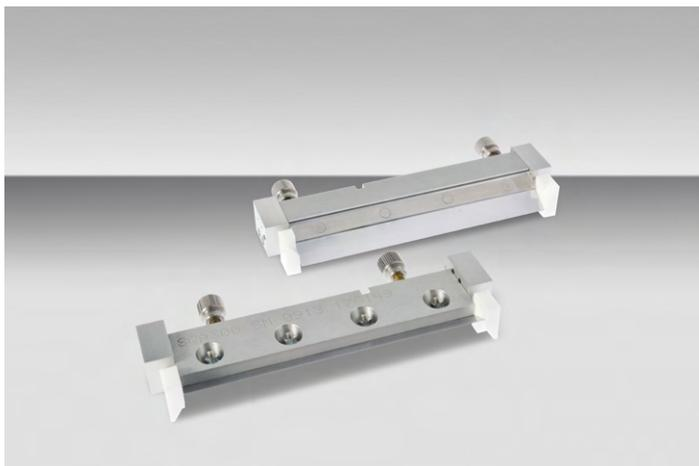
SAPDs sind ideal für den Lotpastendruck auf SMT-Platinen mit Druckkräften zwischen 0 und 20 kg zur Verbesserung der Prozesskontrolle und Verringerung des Lotpastenschwund. Profil und Aufbau der Abweiser sorgen dafür, dass die Paste während des Druckes nicht nach außen entweicht. Das reduziert enorm den Pastenverwurf (schneller ROI) und reduziert drastisch Druckprobleme durch eingetrocknete Randpaste. Damit bleibt vom ersten bis zum letzten Druck eine zuverlässige Leistung erhalten.
