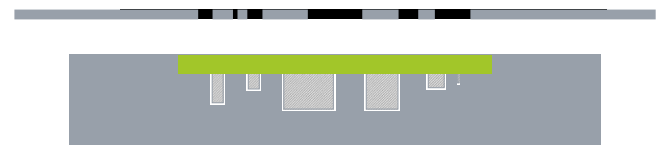
Second Pass / 2. Durchgang – Leiterplattenunterstützung mit Bauteil-Aussparungen
