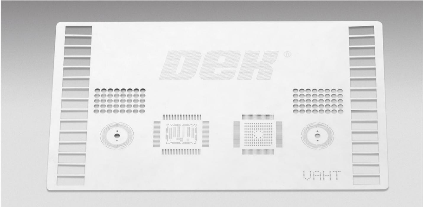
Die DEK Electroform-Schablonen können jederzeit für spezifische Anwendungen modifiziert werden. Eine Variante ist die Variable Aperture Height Technology (VAHT), bei der um die Öffnungen herum, je nach Bedarf, eine Materialerhöhung um die Aperturen erzeugt werden kann. Sie vergrößert die Öffnungshöhe und führt zu erhöhten Volumen der Lotpastendepots.
